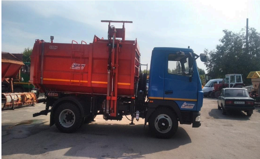
Рис. 27. Сміттєвоз з боковим завантаженням для механізованого завантаження твердих побутових відходів. Джерело: Хмільницька міська рада
