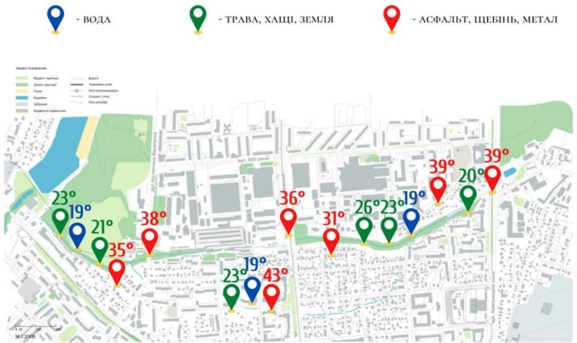
Схема 2.3 Температура міських поверхонь влітку на ділянках по території р. Дьогтянець та її притоці Дьогтянчик, °С
